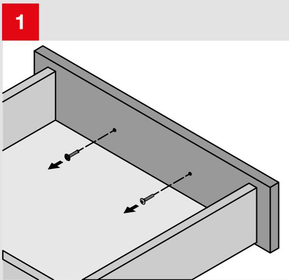
1. Schrauben lösen von der Innenseite der Front
