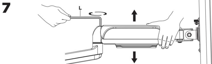
Um den Arm bei montierten Monitoren richtig auszubalancieren, stellen Sie die Federspannung mit den mitgelieferten Inbusschlüsseln wie folgt ein:
