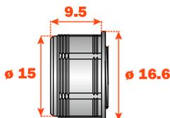
Verstellbares magnetisches Verschlusssteil.
